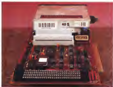
La scheda subito dopo aver montato il 1/2 inch. un ProDrive da 40 Mbyte della Quantum. Si scatta questa connettore SIMM, pronto a contenere fino ad 8 Mbyte di RAM.
